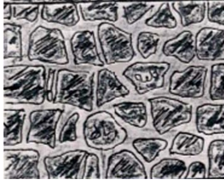
شكل (3) جدار بأحجار مقلبة
