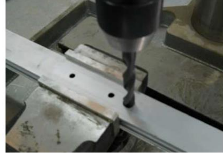
شكل رقم ٦٦: عملية ثقب القطاع العمودي الشكل وتركيب المقبض به
