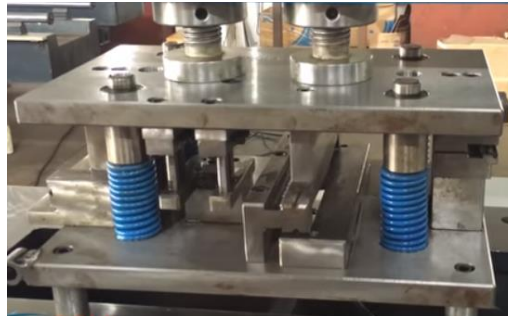
شكل رقم ١١: مكبس هيدروليكي لتفتيح قطاعات الألومنيوم
