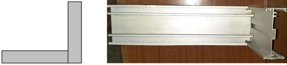
شكل رقم ٥٧: عملية تجميع ركن الحلق
