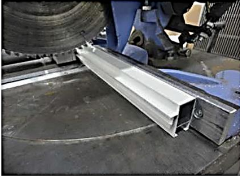
شكل رقم ٤٥: عملية قطع التمرين بالمنشار الدائري
