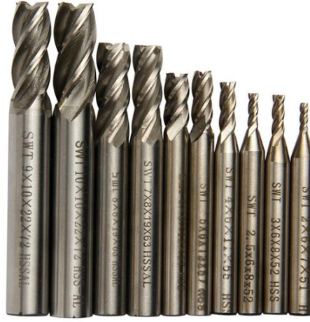
شكل رقم ٩: بعض أنواع سكاكين التفريز
