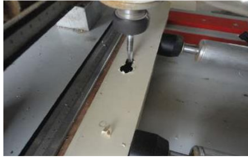
شكل رقم ١٠: عملية تفريز قلب كالون
