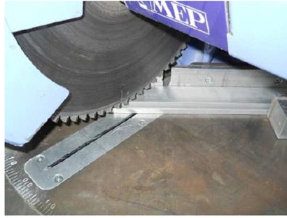
شكل رقم ٧٠: عملية قص القطاع بالمنشار الدائري
